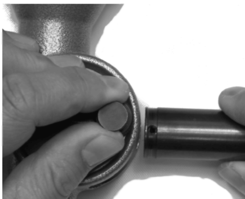
Регулировка отверстия регулировочного винта в сборе с помощью стопорного штифта
