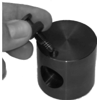
Установка стопорного штифта
